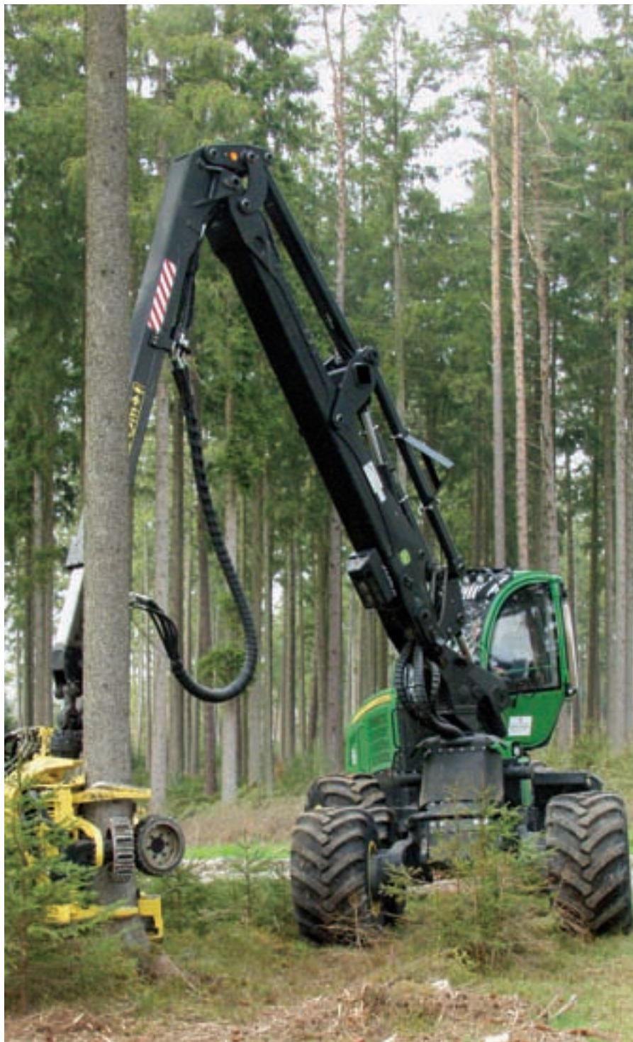
Leveät renkaat tasapainottavat konetta tehokkaasti suurten runkojen korjuussa.
