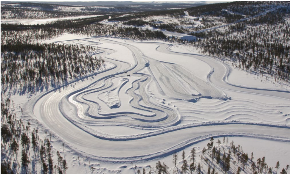
Nokian Renkaiden talvirenkaat testataan Ivalon White Hell -testikeskuksessa, ajamalla kerta toisensa jälkeen lumessa, rännässä ja jäällä.
