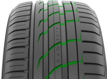
Mehrere Innovationen bekämpfen die permanente Aquaplaning-Gefahr. Aggressive Messer-Rillen in den Mittelrippen speichern Wasser und leiten es in die Längsrillen. Trompeten-Rillen im Schulterbereich verbessern die Sicherheit. Die geschossförmigen Vertiefungen speichern Wasser, das zwischen Reifen und Strasse war, beschleunigen den Wasserfluss von den Hauptrillen in Richtung Querrillen und maximieren den Grip sogar auf regennassen Strassen.
