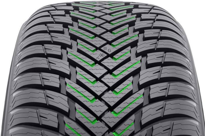
Tiefe und offene Kanäle auf den Blöcken in der Mitte (Zentrale Blockrinnen) erhöhen den Griff unter extremen Bedingungen. Die Kanäle arbeiten auch mit voller Kraft bei Nässe. Sie schieben wirkungsvoll Schneematsch und Wasser zwischen Reifen und Straße weg, was Schneematsch-Aquaplaning und Aquaplaning verhindert. Die exzellenten Aquaplaning-Eigenschaften werden durch die polierten Rillen optimiert, die das Entfernen von Wasser und Schneematsch beschleunigen.
