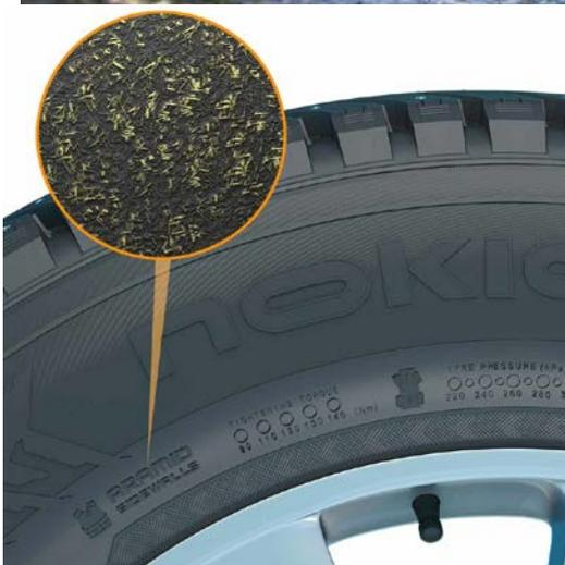
La fibra aramidica rafforza i pneumatici e salva la vita. Le fibre estremamente resistenti vengono impiegate con successo anche nel settore aeronautico e degli armamenti. I pneumatici dei SUV sono molto soggetti ai danni sui fianchi. Nokian Tyres è il primo produttore di pneumatici che impiega la fibra aramidica per i fianchi. I nuovi pneumatici estivi Nokian SUV, Nokian Line SUV e Nokian zLine SUV, sono già dotati della
