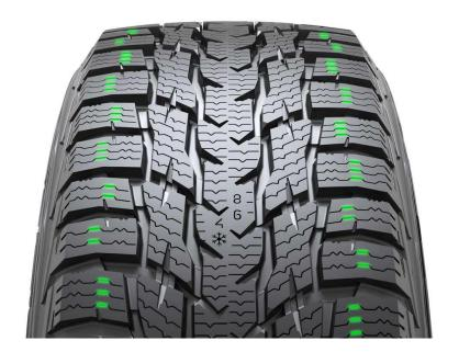
Per massimizzare l'aderenza a velocità più elevate e in condizioni di imprevedibilità, i tasselli del profilo sulla spalla sono provvisti di lamelle a forma di tasca. Le lamelle rimuovono o addirittura pompano via l'acqua dalla superficie stradale, garantendo così un'aderenza sicura e stabile. Queste lamelle a pompa brevettate amplificano incredibilmente l'aderenza sul bagnato.
