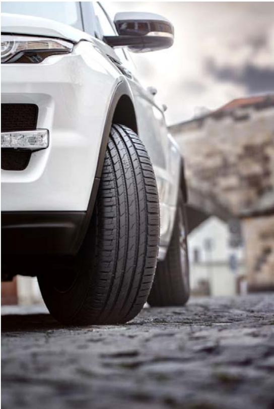
Die Festigkeit dieses SUV-Pneus wird erhöht und seine Lebensdauer wird verlängert mit Aramid-Fasern, die der nördlichste Reifenhersteller der Welt aus Finnland einsetzt. Das aus der Flugzeug- und Rüstungsindustrie bekannte Aramid vermindert Seitenwandschäden, die bei SUV-Reifen häufig eintreten. Mehrere Innovationen im Nokian Line SUV verbessern den Nassgriff, maximieren den Aquaplaning-Schutz und machen diesen vielseitigen Qualitätsreifen zu einem der besten seiner Klasse.
