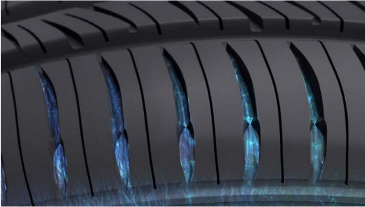
Der Nokian iLine verfügt über stabile Fahreigenschaften - auch bei plötzlichem Unwetter oder heimtückischem Aquaplaning. Die Venturi-Rillen auf der inneren und äußeren Schulter beugen Aquaplaning vor. Diese geschwungenen Rillen zwischen den Profilblöcken im Schulterbereich beschleunigen das Abfließen von austretendem Wasser.
