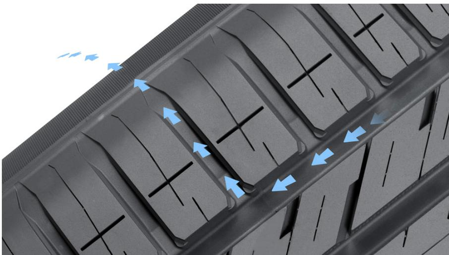
Die Nokian Tyres Coanda Technologie entfernt das Wasser schneller aus der Längsrille und verhindert Aquaplaning. Das kurvenförmige, rampenartige Design der Laufflächenblöcke auf der Innenschulter leiten und beschleunigen das Wasser aus der Längsrille in die Querrille. Der Coanda-Effekt bezeichnet die Tendenz einer Strömung, „abzubiegen“ zu einer nahen Oberfläche. Der
