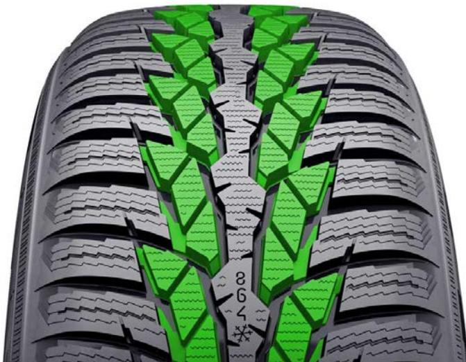
Eine Lenkpräzisionsrippe beherrscht die Fläche in der Mitte und bewirkt präzises Steuern auf trockenen Strassen. Die Lamellen der massiven Mittelrippe laufen nicht über ihre volle Breite, was die Präzision erhöht und für kontrolliertes Handling sorgt.
