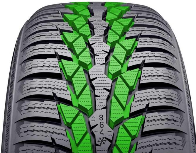
Eine Lenkpräzisionsrippe beherrscht die Fläche in der Mitte und bewirkt präzises Steuern auf trockenen Straßen. Die Lamellen der massiven Mittelrippe laufen nicht über ihre volle Breite, was die Präzision erhöht und für kontrolliertes Handling sorgt.
