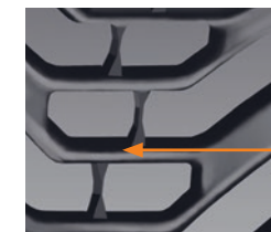
Nokian ELS L-2 tread depth measuring point
