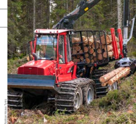
schützt dies die Reifen und die Bogie-Gehäuse insbesondere unter anspruchsvollen Bedingungen vor Beschädigungen.
