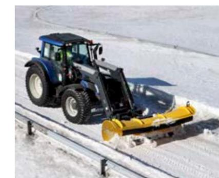
Winterwartung, mit Schneeräumen und Streuen. Die Reifen müssen über einen ordentlichen Griff verfügen. Aggregate, wie Schaufeln, Pflüge und Anhänger, tragen ihrerseits dazu bei, wie sich eine Maschine mit bestimmten Reifen verhält. Daher wurden im Rahmen des Testtages auch Aggregate von Traktoren eingesetzt, fährt Herr Kaivonen fort.
