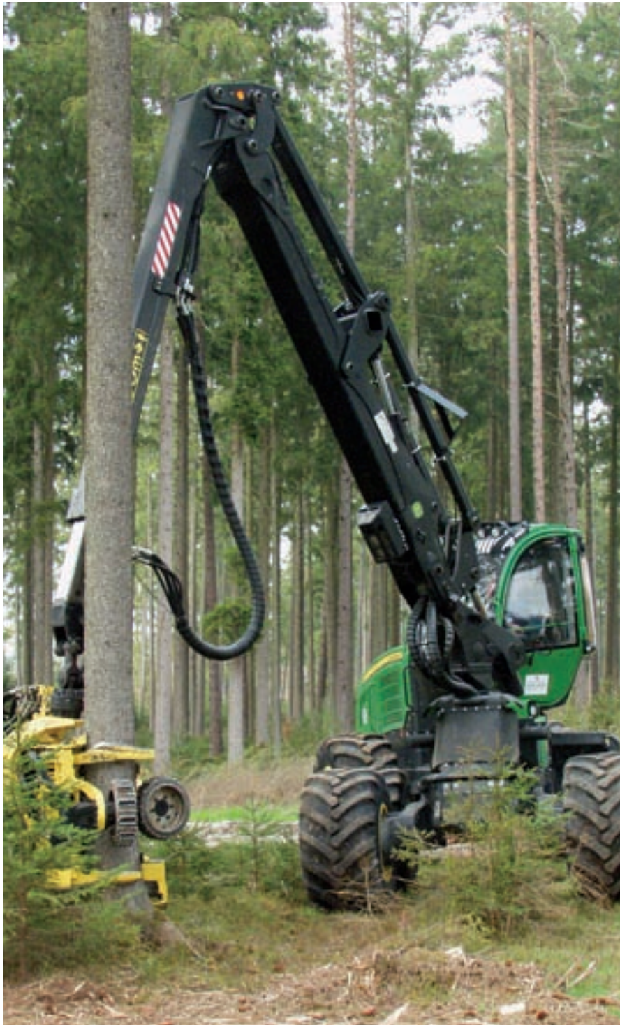
Breite Reifen sichern eine gute Stabilität des Harvesters beim Fällen der schweren Bäume.
